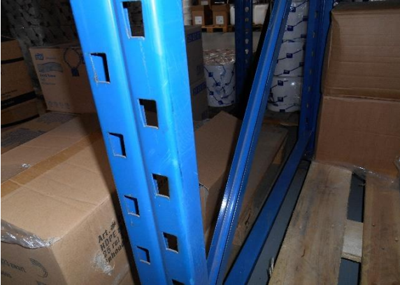
Dit juk staat achterstevoren, de diagonaalschoor wijst naar beneden en naar voren
